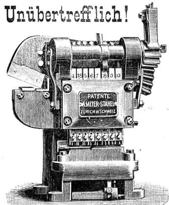
Ohne das Geringste ändern zu müssen, können nachstehende Arbeiten gemacht werden: Löcher in Eisendicken bis 10 mm von 4, 4 $\frac{1}{2}$ , 5, 6, 7, 8, 9, 10 mm. Scheere für Flach-eisen 10 auf 50 mm, Winkeleisen 35 mm, Rund-eisen 15 mm.
