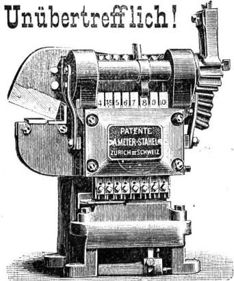
Ohne das Geringste ändern zu müssen, können nachstehende Arbeiten gemacht werden: Löcher in Eisendicken bis 10 mm von 4, 4½, 5, 6, 7, 8, 9, 10 mm. Scheere für Flach-eisen 10 auf 50 mm, Winkeleisen 35 mm, Rund-eisen 15 mm.
