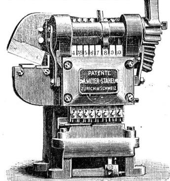
Ohne das Geringste ändern zu müssen, können nachstehende Arbeiten gemacht werden: Löcher in Eisendicken bis 10 mm von 4, 4½, 5, 6, 7, 8, 9, 10 mm. Scheere für Flach-eisen 10 auf 50 mm, Winkeleisen 35 mm, Rund-eisen 15 mm.
