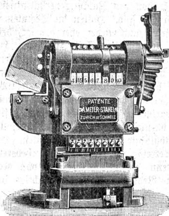
Ebenso praktisch wie die Stanze ist auch die links angebrachte Scheere, welche vom gleichen Hebel aus, mit Kolben und Zahnschwinge aus Stahlguß, hinten durch bewegt wird.
