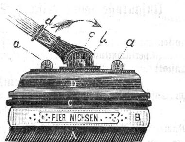
der Auflage des Gusses das Bürstenholz mit einem leicht erzeugbaren Gummiring versehen, um das starke Anprallen der Bürste an Möbeln und Wänden zu verhindern, wogegen bei den bisherigen Blochbürsten zu wenig vorgesorgt war.
