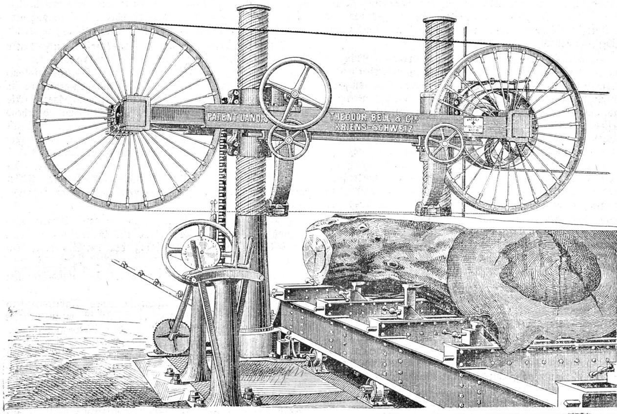
eines Handrades genau, sicher und schnell bewerkstelligt werden, erreicht die Säge eine außerordentlich große Leistungsfähigkeit bei absolut genauem, glattem und dünnem Schnitt, wie er mit dem Bölgatter nicht erzielt werden kann.
