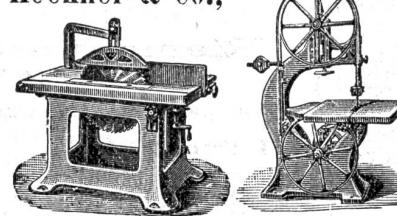
Kreissäge. Bandsäge. Fräz-Maschine.
