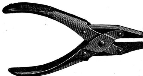
durch seitliche Anordnung von Doppelcharniere ist die Zange nach hinten offen — es können deshalb durchgesteckte Drähte an jeder beliebigen Stelle mit der ganzen Länge des Maules gefaßt werden — dadurch werden die Drähte selbst beim stärksten Anziehen nicht gequetscht oder flach gedrückt. Die Schenkel sind aus Stahlblech gepreßt und daher die Zangen, die in 12, 14, 16 cm. Länge gemacht werden, sehr leicht. Zu beziehen bei Wittwe A. Karcher, Werkzeuggeschäft, Zürich.
