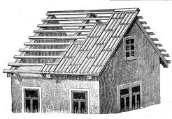
123] In Zink, verzinktem Blech und Eisen. Leichte, sehr dauerhafte und geschmackvolle Bedachung — besonders für umzudeckende Dächer geeignet, deren Dachstuhl für Ziegel zu schwach ist. Transport sehr leicht und bequem, können auf Latten oder Schalung angebracht werden.
