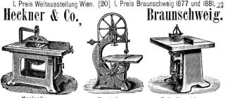
Kreissäge. Bandsäge. Fräs-Maschi Spezialfabrik für Holzbearbeitungs-Maschinen. Fräs-Maschine.
