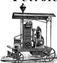
(eidg. Patent Nr. 4454) einfachster und billigster Motor der Gegenwart; solide und dauerhafte Konstruktion. Absolut gefahrloser und ununterbrochen sicherer Betrieb. Die Lager, sowie alle beweglichen und reibenden Theile sind im Kurbelwellen. kasten dicht abgeschlossen und daher vollkommen vor Staub géschützt.
