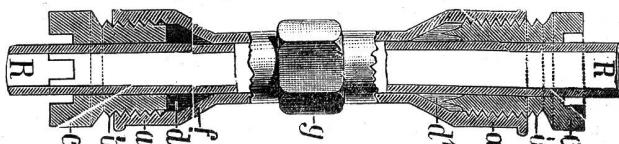
Diese **beste, vortheilhafteste Verbindung von Gas- oder Wasserleitungen**, die es ermöglicht, **Röhren zu verbinden, ohne dass dieselben Gewinde brauchen**, liefert zu den billigsten Preisen
