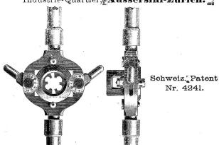
Schneidkluppen für Gasrohre neuester Konstruktion. Gewindschneidzeuge aller Systeme.
