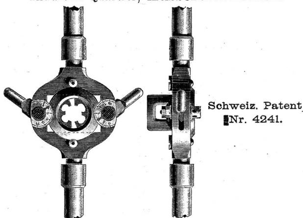
**Schneidekluppen für Gasrohre neuester Konstruktion. Gewindschneidzeuge aller Systeme.**
