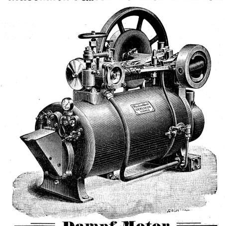
für Betrieb von kleinern gewerblichen Anlagen und von elektrischen Beleuchtungs-Einrichtungen. — Selbstthätige, rauchlose Feuerung mittelst Coaks, oder Feuerung mit Steinkohlen. — Speisewasservorwärmer mit selbstregulirender, continuirlicher Kesselspeisung. — Eventuell Oberflächen-Condensation, wo nur hartes Speisewasser erhältlich ist. Wird gebaut in Grössen von 2-3, 5-6 und 10-12 HP.
