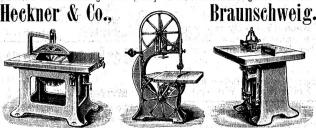
Kreissäge. Bandsäge. Fräs-Masch Spezialität für Holzbearbeitungsmaschinen.
