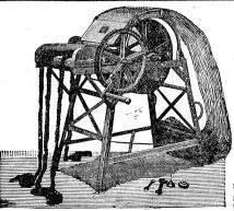
Anerkannt beste Zupf-Maschine Polstermaterial jeder Art mit Vorrichtung zum Aufdrehen der Stränge.
