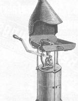
Feldschmiede mit Cylindergebläse, mit oder ohne Rauchfang und Wasserbehälter, drehbarem Hebel zum drücken und treten. In sechs
