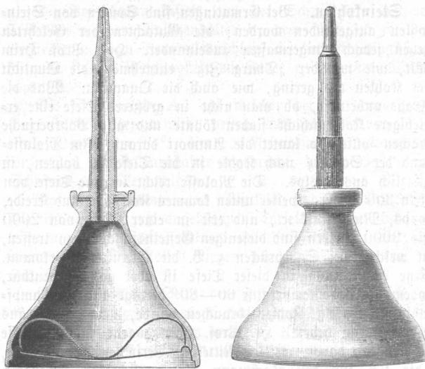
Die Pfeife ist oberhalb der Verschraubung geriffelt, um dieselbe beim Füllen leicht abzuschrauben zu können. Dadurch daß die Riffelung an der Pfeife, anstatt am Flansch angebracht wurde, konnte die Füllöffnung schalenförmig gestaltet werden, welches ermöglicht, die Kanne ohne einen Tropfen Öl zu vergießen, füllen zu können.
