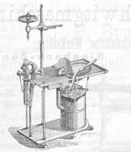
Feldschmiede mit Werktisch, Schraubstock, Bohrmaschine, Schublade, in verschiedenen Modifikationen und 3 Grössen.
