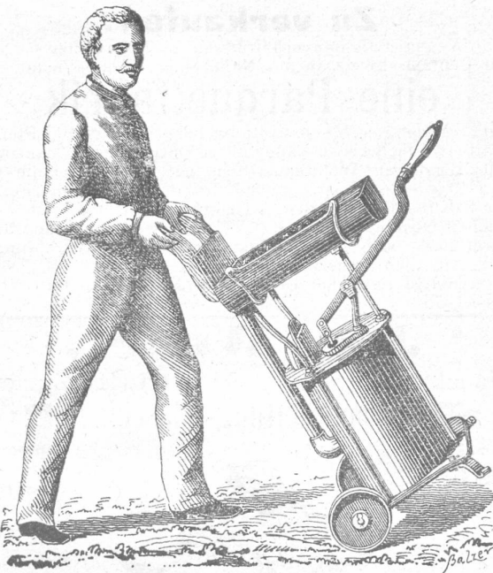
Fahrbare Feldschmiede mit drehbarem Hebel zum Drücken; in 6 Grössen.
