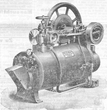
für Betrieb von kleinern gewerblichen Anlagen und von elektrischen Beleuchtungs-Einrichtungen. — Selbstthätige, rauchlose Feuerung mittelst Coaks, oder Feuerung mit Stein-Speisewasservorwärmer mit selbstregulirender, continuirlicher Kesselspeisung. kohlen. -Eventuell Oberflächen-Condensation, wo nur hartes Speisewasser erhältlich ist.
