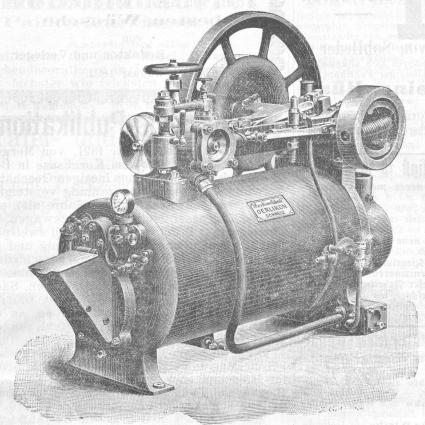
für Betrieb von kleinern gewerblichen Anlagen und von elektrischen Beleuchtungs-Einrichtungen. - Selbstthätige, rauchlose Feuerung mittelst Coaks, oder Feuerung mit Steinkohlen. - Speisewasservorwärmer mit selbstregulirender, continuirlicher Kesselspeisung. Eventuell Oberflächen-Condensation, wo nur hartes Speisewasser erhältlich ist.
