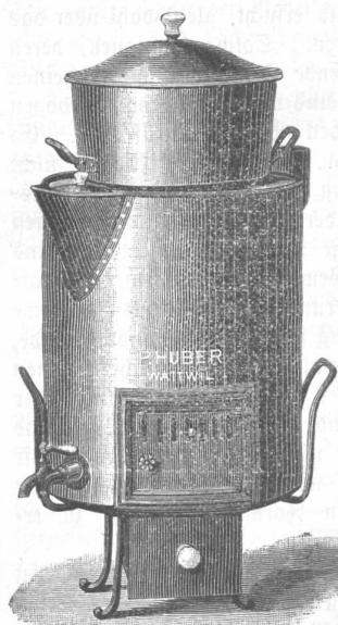
Wenn nun gefeuert wird, so erhält man das im Ofen befindliche Wasser (etwas mehr als im eigentlichen Waschhafen) gratis warm. Hierdurch, sowie durch die vorzügliche Feuerungsanlage werden bis 50% Brennmaterial erspart. Das warme Wasser wird oben ausgelassen, indem man das kalte Wasser unten einströmen läßt, sei es durch einen Trichter mit Rohrverbindung oder durch die Druckwasserleitung. Im Winter soll der Ofen entleert werden, damit das Wasser nicht einfriert und den Kessel zerreißt.
