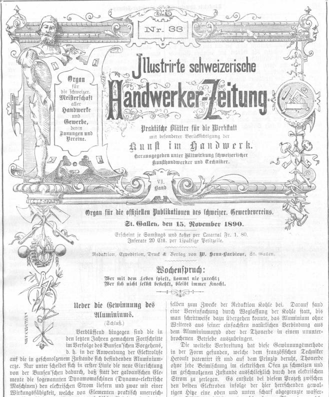
Anfangs für galvanoplaftische Arbeiten fonftruirt, gewann die Dynamomaschine in ber Glektolyfe bald eine größere Verwendung bei der Gewinnung von Rupfer u. dgl. aus mäfferigen Löfungen, um bann gu ber Erfinbung bes elettrischen Schmelzofens zu führen, bem die Gewinnung bes Muminiums in bem jegigen Umfange zu verdanken ift.
