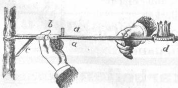
aus zwei nebeneinander laufenden, aus bestem Flachdraht gefertigten Armen. Der vordere Theil derselben trägt die zur Aufnahme des Lichtes
