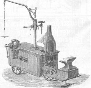
Montir-Schmiede (dieselbe erlitt nach Abbildung mehrfache Aenderungen), bequem fahrbar, mit Ambos, Schraubstock und Bohrmaschine, grossem verschiebbarem Werkzeugschrank; in 3 Grössen.
