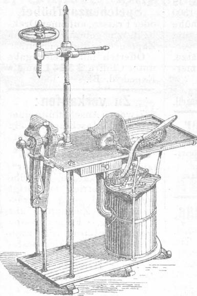
**Feldschmiede** mit Werkstisch, Schraubstock, Bohrmachine, Schuhblade. In verschiedenen Modifikationen und drei Grössen.
