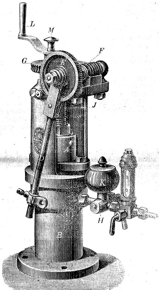
Patent-Dampf-Oelungs-Apparat und es ist seine Einrichtung folgende:
