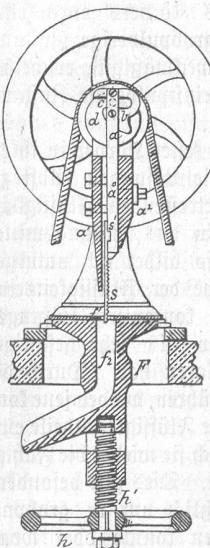
dem Arbeitsstücke — heraushebt und die freie Bewegung desselben auf dem, in verschiedener Höhe je nach der Dicke des Arbeitsstückes durch Handrad  $h$  und  $h^1$  einstellbaren Tische gestattet.
