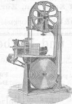
binirt mit Langlochbohrmaschine u. Abrichtmaschine für Stäbe, bis 260 mm breit, praktisch für Glasereien und Goldleisten-
