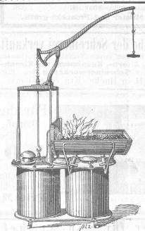
Gross zweicylindrige doppeltblasende Feldschmiede mit drehbarem Hebel zum Ziehen. Boden- und Deckelplatte von Guss, Esse von Eisenblech.
