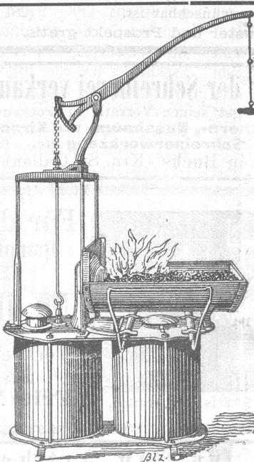
Gross zweicylindrische doppelblasende **Feldschmiede** mit drehbarem Hebel zum Ziehen. Boden- und Deckelplatte von Guss, Esse von Eisenblech.
