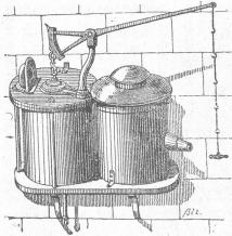
Grosses, zweicylindriges Gebläse mit drehbarem Hebel zum Ziehen mit Sicherheitsventil gegen Explosion; Boden und Deckelplatte von Gusseisen. Für Schlosser und Schmiede etc. Vor-
