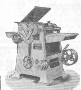
binirt mit Langlochbohrmaschine u. Abrichtmaschine für Stäbe, bis 260 mm breit, praktisch für Glasereien und Goldleistenfabriken;
