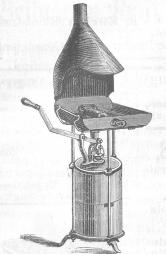
Kleine, einfach und doppeltblasende Feldschmiede mit drehbarem Hebel zum Drücken und Treten. Gusseiserne Esse-, Boden- und Deckelplatten. [204
