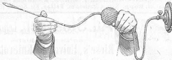
Leuchtgas (ohne Luftpumpe) betrieben; er entwickelt bei einem auffallend geringen Gasverbrauch die enorme Hitze von 1200° Celsius und bringt dadurch z. B. Gold in kurzer Zeit zum Fließen.
