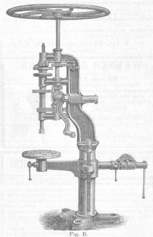
Ständer-Bohrmaschine für Hand- und Kraftbetrieb, mit drehbarem korizontal und vertikal verstellbarem Tisch und Paralellschraubstock, Selbstschaltung und 2 Geschwindigkeiten.
