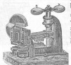
zum Schneiden und Stanzen von 4-15 m/m starkem Blech und zum Gesenken nach jeder beliebigen Façon; nach Verlangen auch mit Motorbetrieb.
