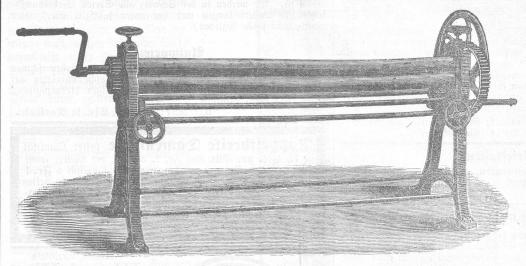
Fig. G. Rohrbiegmaschine
