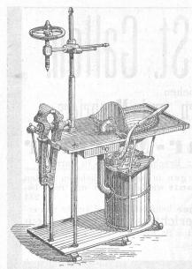
Fig. E. Feldschmiede mit Werktisch, Schublade, Schraubstock und Bohrmashine, mit drehbarem Hebel zum drücken, oder zum treten; Tisch und Bodenplatte aus Schmiedeisen, Esse und Deckelplatte aus Gusseisen
