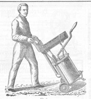
Kleine, doppeltblasende, fahrbare Feldschmiede mit drehbarem Hebel zum drücken; gusseiserner Esse-, Boden- u. Deckel-
