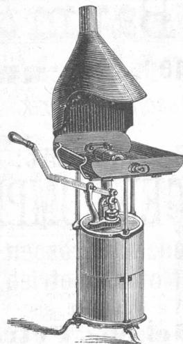
Kleine einfache und doppelbläsende **Feldschmiede** mit drehbarem Hebel zum Drücken oder Treten. Gussferne Eße, Boden- und Deckelplatten.
