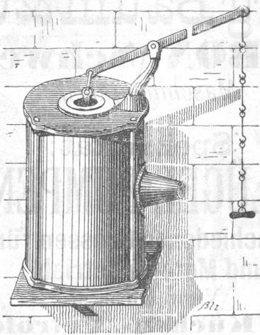
Kleines, eingeschlindriges doppeltbläsendes **Gebläse**, mit drehbarem Hebel zum ziehen. Sicherheitsventil gegen Explosion. Boden und Deckelplatte von Guß-isen. Für Schmiede und Schlosser z. R.
