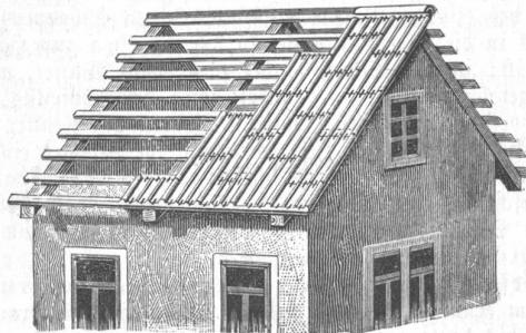
In Zink, verzinktem Blech und Eisen. Leichte, sehr dauerhafte und geschmackvolle Bedachung. Besonders für umzudeckende Dächer geeignet, deren Dachstuhl für Ziegel zu schwach ist. Transport sehr leicht und bequem, können auf Latten oder Schalung angebracht werden. (1270)
