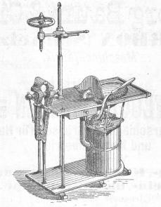
Felbichmiede mit Berkifch, Schublabe, Schraubstod und Bohrmaichine, mit breibarem hebel jum Drücken ober jum Treten; Tijch und Bobenplatte aus Schmiebeisen, Effe und Deckelplatte aus Gustien.
