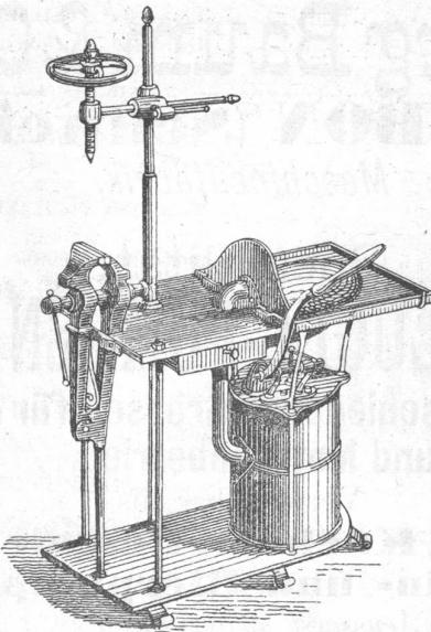
**Feldschmiede** mit Werktafel, Schublade, Schraubstock und Bohrmaschine, mit drehbarem Hebel zum Drücken oder zum Treten; Tisch und Bodenplatte aus Schmiedefisen, Eise und Deckelsplatte aus Gussisen.
