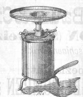
Schmiebe, fpeziell für Golds und Silberarbeiter, jum Bergolben, Schmelgen, Böthen ze. Dit brebbarer Ssieplatte, Windthelthabnen, Windelntritt von unten, und Wind burch ein anzuschraubendes Gummirohr von oben. — EffesBoben Dedelplatte von Guß. — Windthelthabnen in Bronce.
