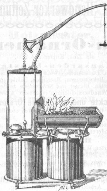
Groß zweicylindrig doppelbläsende **Feldschmiede** mit drehbarem Hebel zum Ziehen. Boden- und Deckplatte von Guß, Eße von Eisenblech.
