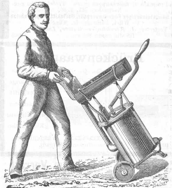
Feldschmiede, kleine, doppelbläfende, fahrbare, mit drehbarem Hobel zum Drücken; gutgefertigter Esse, Boden- und Deckelplatte.
