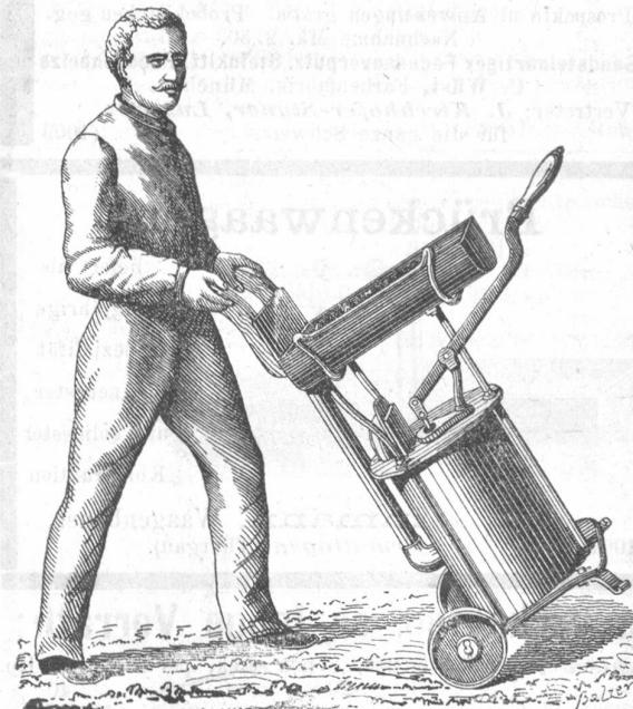
Feldschmiede, kleine, doppelbläufende, fahrbare, mit drehbarem Hobel zum Drücken; gutfeuernder Ofen, Boden- und Deckplatte.
