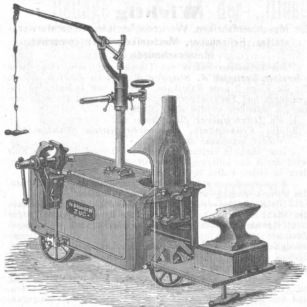
**Montirapparat**, ganz Eigenkonstruktion, drehbarem Hebel zum Ziehen und Treten. Mit zwei geräumigen, verlängerbaren Werkzeugkästen, Kohlenkästen, Schraubstock, Bohrmaschine, Ambos samt Vorrichtung dazu.
