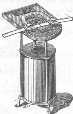
**Vöthschmiede**, speziell zum Löthen von Bandäggen, Spitzen und Härteln kleiner Werkzeuge, mit gußfeiner Esse, Boden- und Deckelplatte, zum Drehen.
