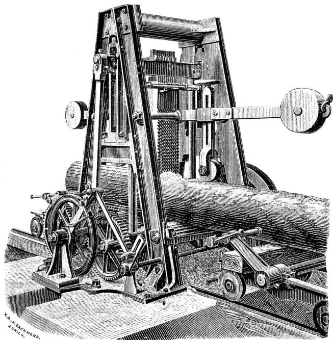
starken Holzrahme. Die Gatterstände sind von Schmiedeisen (U-Eisen) wie überhaupt das meiste und das Gatter selbst ganz aus Schmiedeisen und Stahl besteht, um den Bau der Maschine möglichst leicht und doch solid bewerkstelligen zu können.
