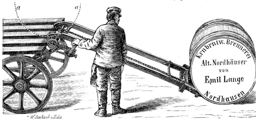
auf der Hand liegen, gehört die Hrn. W. R. Stegmann in Leipzig patentirte „Mechanische Schrotleiter.“
